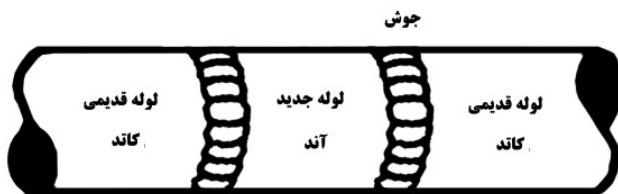
شکل ۹- خوردگی گالوانیکی به علت اتصال لوله‌های نو و کهنه
