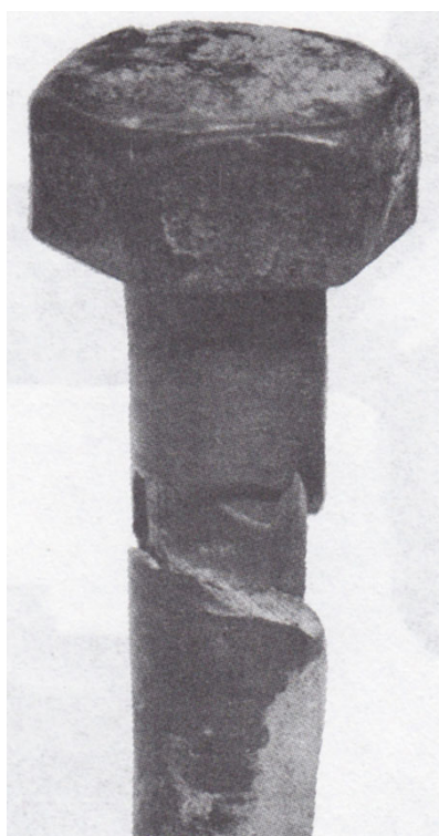
شکل ۱۲-۱۴: پیچ برنجی سربداری به قطر ۱۲ mm که روی‌زدایی شده است؛
